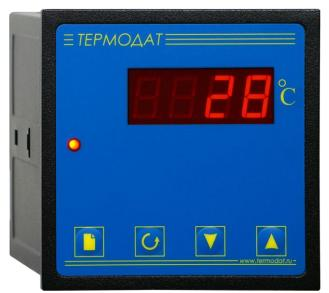
Термодат-10И5 предназначен ДЛЯ температуры измерения С помощью термопары, термосопротивления, потенциального датчика или датчика унифицированным ТОКОВЫМ сигналом. Аналоговый выход СЛУЖИТ ДЛЯ преобразования измеренной температуры в ток. Металлический корпус обеспечивает защиту ІР54. Термодат-10И5 внесен Госреестр, № 17602-09. Прост в настройке и управлении.
