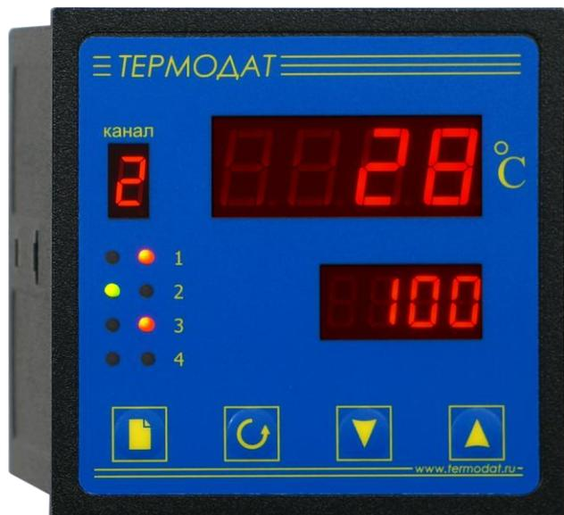
Термодат-13К5 – это трехканальный промышленный регулятор температуры с большим набором сервисных функций. Все три канала независимы друг от друга. Подходит для автоматизации большинства технологических процессов. Обеспечивает управление мощной печью, холодильником, вентилятором и т.д. Работает с любым типом датчика. Имеет развитую систему аварийной и предупредительной сигнализации. Измеряет и регулирует температуру с высокой точностью.
