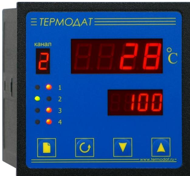
Термодат-13К5 – это четырехканальный промышленный регулятор температуры с большим набором сервисных функций. Подходит для автоматизации большинства технологических процессов. Обеспечивает управление мощной печью, холодильником, вентилятором и т.д. Работает с любым типом датчика. Измеряет и регулирует температуру с высокой точностью. Имеет развитую систему аварийной и предупредительной сигнализации.
