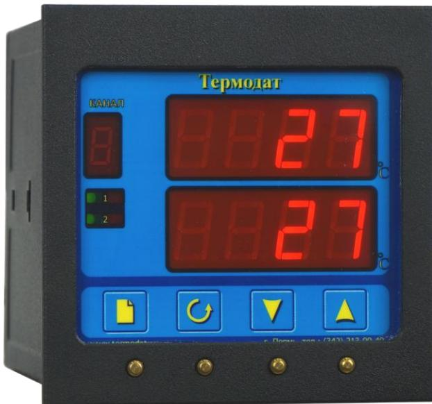
Термодат-13КХ3 – это двухканальный промышленный регулятор температуры с большим набором сервисных функций. Обеспечивает измерение и регулирование температуры с высокой точностью на двух каналах одновременно. Управляет печью, холодильником, вентилятором или др., которые подключаются к реле прибора. Оснащен интерфейсом для связи с ПК. Подходит для автоматизации большинства технологических процессов.
