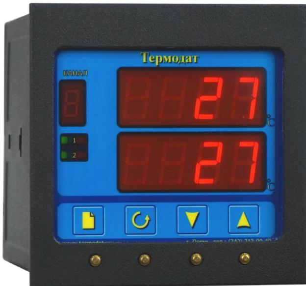
Термодат-13КХ3 – это двухканальный промышленный регулятор температуры с большим набором сервисных функций. Обеспечивает измерение и регулирование температуры с высокой точностью на двух каналах одновременно. Управляет печью, холодильником, вентилятором или др., которые подключаются к реле прибора. Оснащен архивной памятью и интерфейсом для связи с ПК. Подходит для автоматизации технологических процессов.
