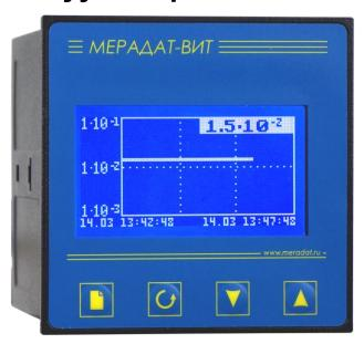
ВИТ16Т3 Вакуумметр предназначен измерения давления сухого воздуха и азота в вакуумных системах приборов лабораторного назначения. Прибор промышленного поддерживает работу с преобразователями ПМТ-2. ПМТ-4, ПМТ-4М, ПМТ-6-3 ПМТ6-3M-1. Имеет графический дисплей жидкокристаллический ДЛЯ отслеживания измеренных значений В динамике. Давление отображается на экране прибора паскалях или миллиметрах столба. Прибор оснащен ртутного двумя настраиваемыми аварийными реле,
