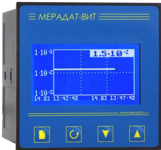
Вакуумметр ВИТ16Т3/А предназначен для измерения давления сухого воздуха и азота в вакуумных системах приборов лабораторного и промышленного назначения. Прибор поддерживает работу с преобразователями ПМТ-2, ПМТ-4, ПМТ-4М, ПМТ-6-3 и ПМТ6-3М-1. Прибор оснащен настраиваемыми аварийными реле и аналоговым выходом для трансляции измеренного давления. Энергонезависимая память служит для хранения архива измерений, а интерфейс RS485 позволяет организовать работу с ПК.
