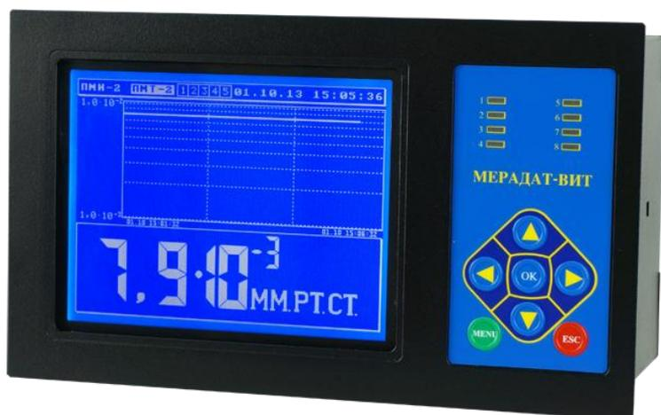
Вакуумметр ВИТ19ИТ1 предназначен для измерения давления сухого воздуха и азота в вакуумных системах приборов лабораторного и промышленного назначения. Прибор имеет большой жидкокристаллический графический дисплей, что позволяет отслеживать изменение давления во времени на экране прибора. Прибор поддерживает работу с тепловыми и
