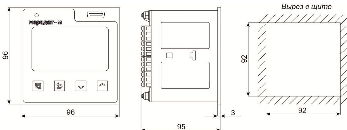
Рисунок 6 – Габаритные размеры основного блока прибора Мерадат-М25М6/...../
