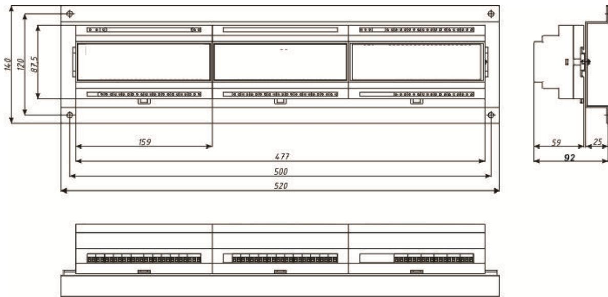
Рисунок 8 – Габаритные размеры блока измерения и блока выходов PV//12DC(0/20)//12P//12P-12A
