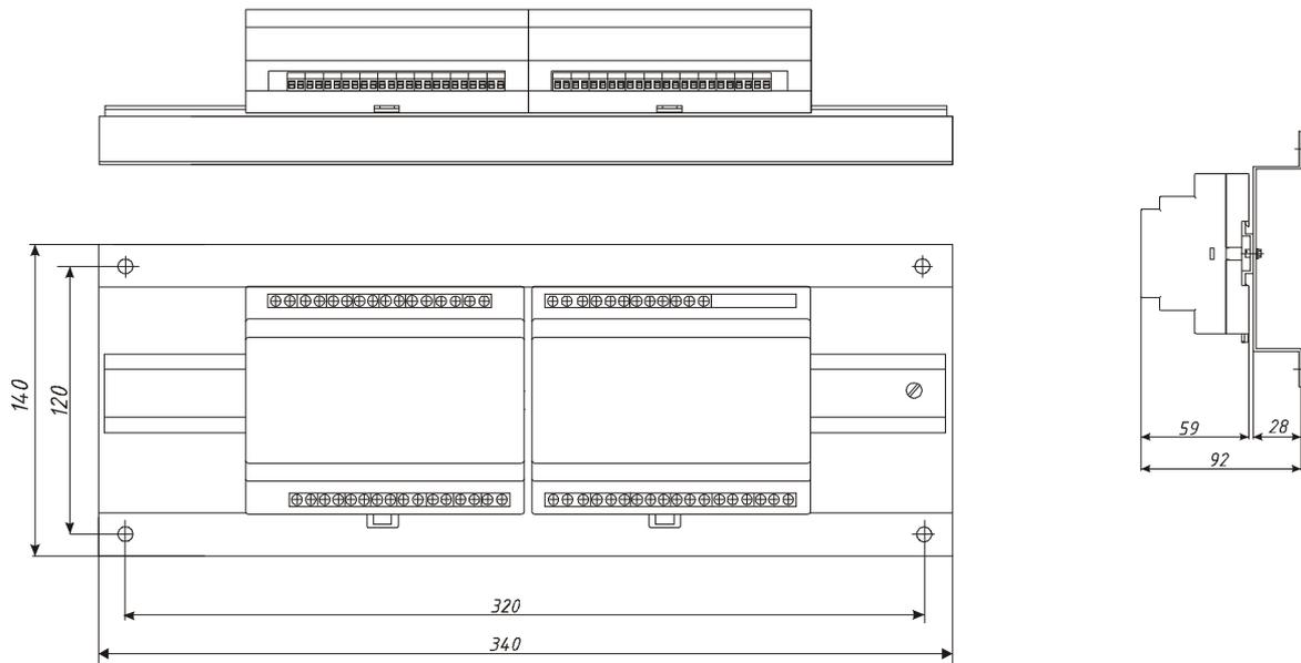
Рисунок 7 – Габаритные размеры блока измерения и блока выходов PV//8(12)DC//8(12)P//8(12)P
