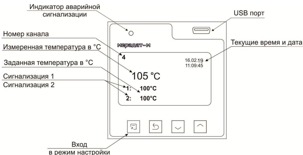
Рисунок 1. Режим индикации «один канал»
