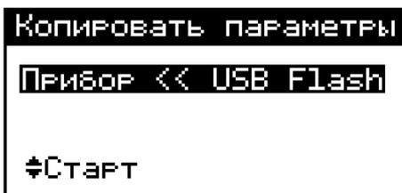
Далее выберите “Старт” и нажмите клавишу  $\nabla$  или  $\wedge$ . Процесс копирования отображается на экране. Завершается процесс копирования следующим сообщением:
