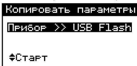
Для выгрузки параметров настройки с USB-flash носителя на прибор необходимо кнопками  $\nabla$  или  $\wedge$  установить направление стрелок в следующем образом:
