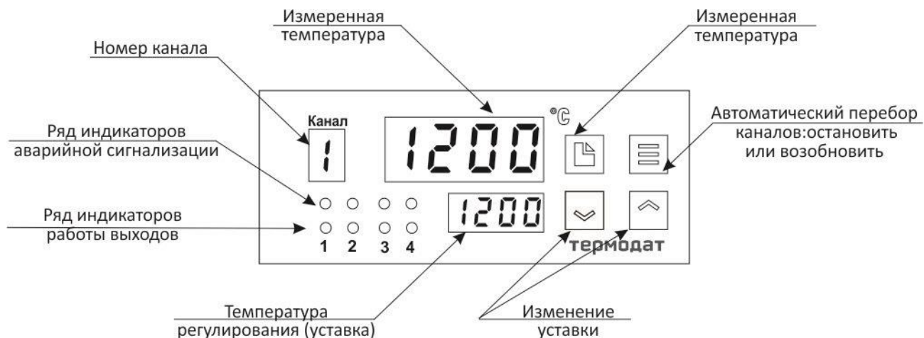
Рисунок 4 – Описание индикаторов и кнопок управления прибора Термодат-13К6-Р6..
