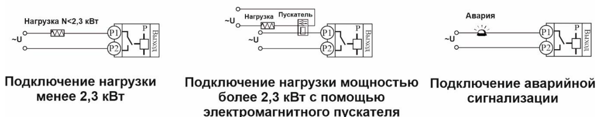
Рисунок 2- Схемы подключения релейных выходов
