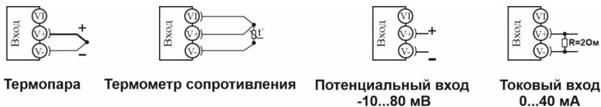
Рисунок 2 – Схемы подключения датчиков
