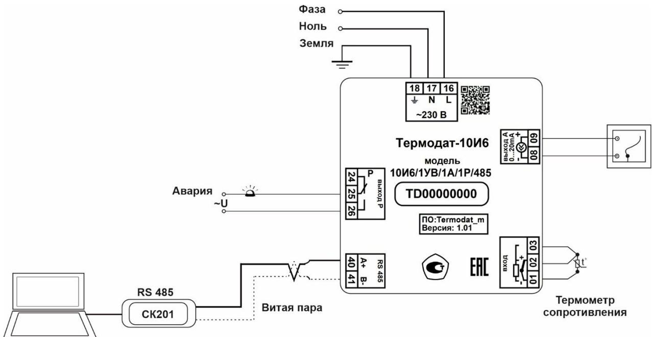
Рисунок 6 – Схема подключения прибора Термдат-10И6
