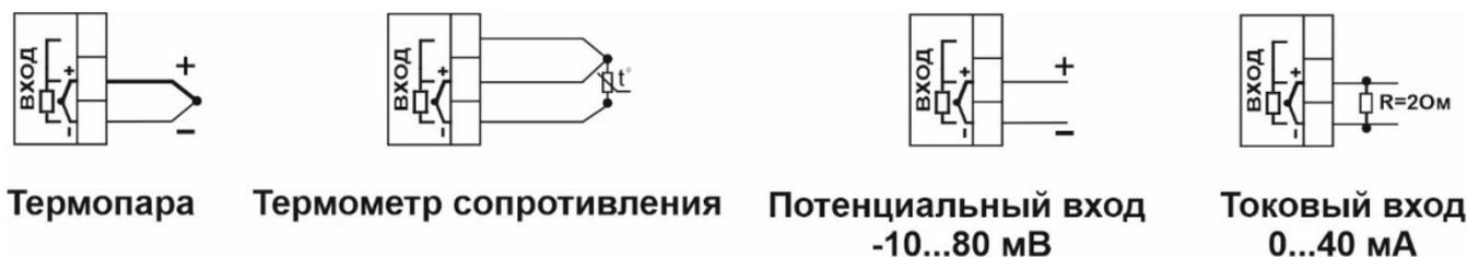
Рисунок 3 – Схемы подключения датчиков температуры
