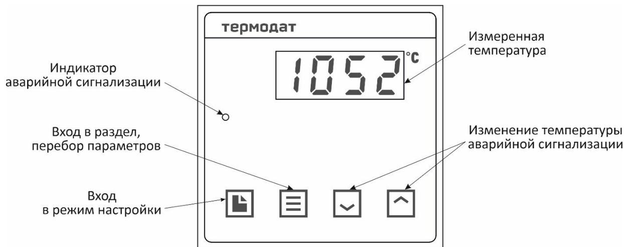
Рисунок 2 – Описание индикаторов и кнопок управления прибора
