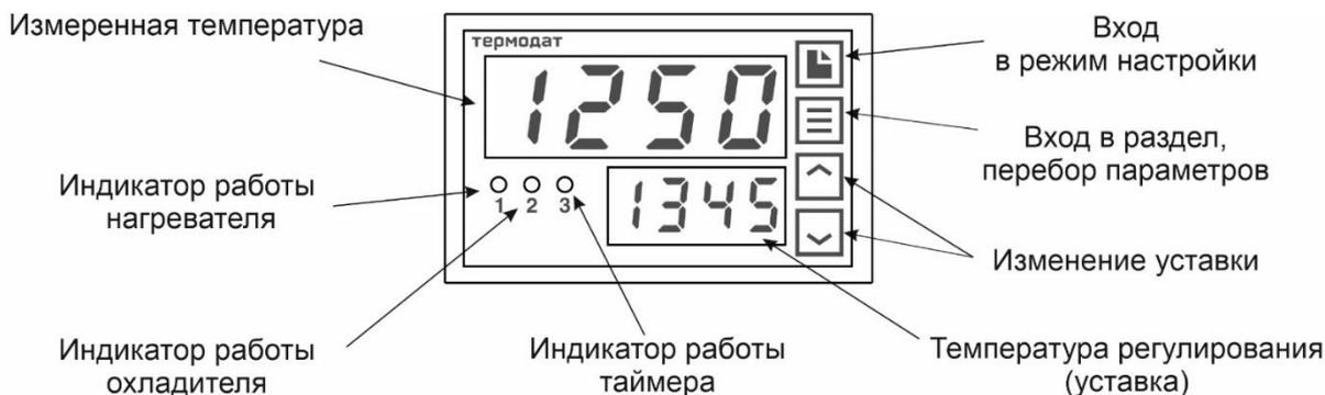
Рисунок 12 – Описание индикаторов и кнопок управления прибора Термодат-10К7-Р4
