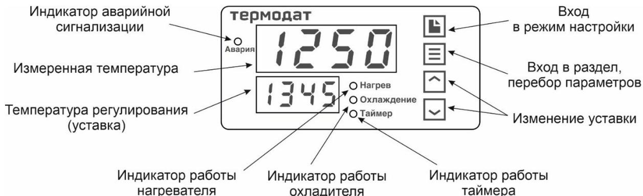
Рисунок 10 – Описание индикаторов и кнопок управления прибора Термодат-10К7-Н
