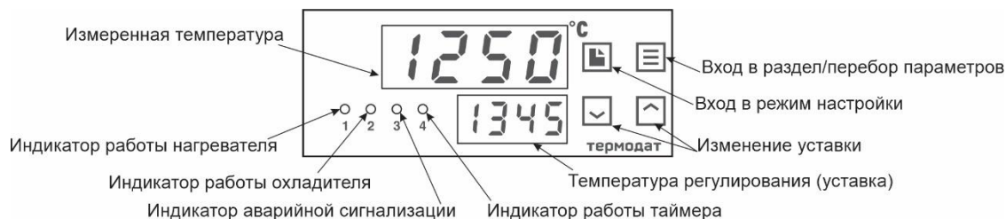
Рисунок 8– Описание индикаторов и кнопок управления прибора 12К6-Р6...
