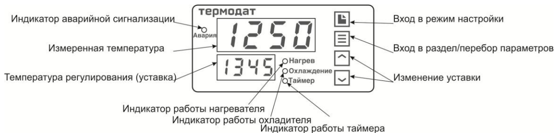
Рисунок 7 – Описание индикаторов и кнопок управления прибора 12К6-Н...
