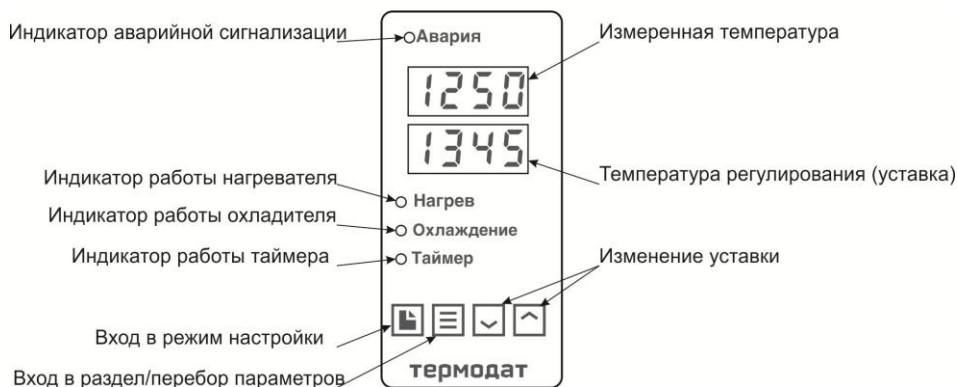
Рисунок 6 – Описание индикаторов и кнопок управления прибора 12К6-В...
