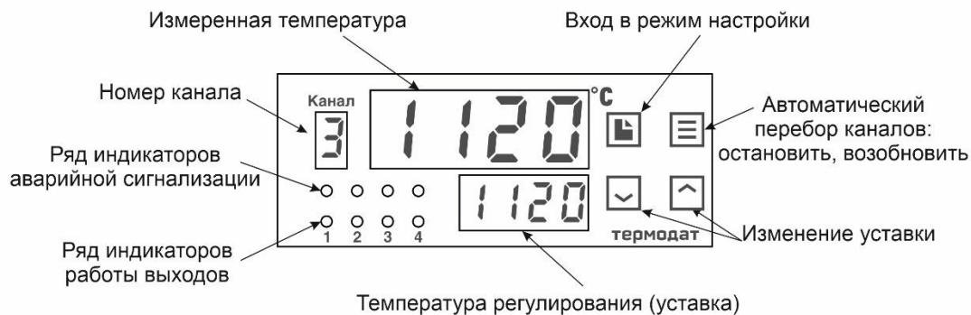
Рисунок 4 – Описание индикаторов и кнопок управления прибора Термодат-13К6-Р6..
