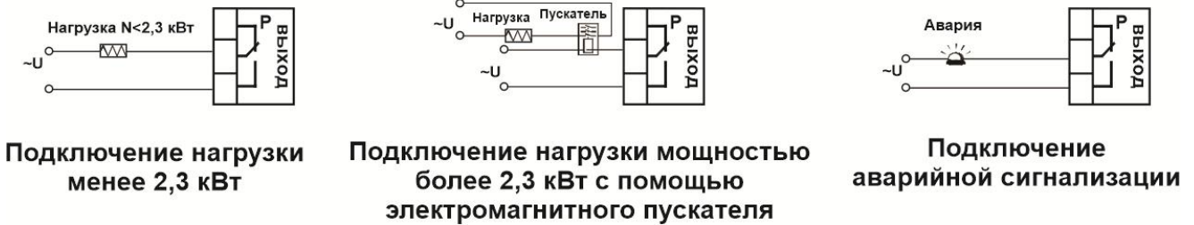
Рисунок 6 – Схемы подключения релейных выходов
