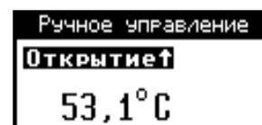
При ПИД регулировании мощность задается в процентах, при двухпозиционном регулировании нагреватель либо включен, либо выключен (да/нет), при управлении электрозадвижкой подаются импульсы открытия или закрытия задвижки.
