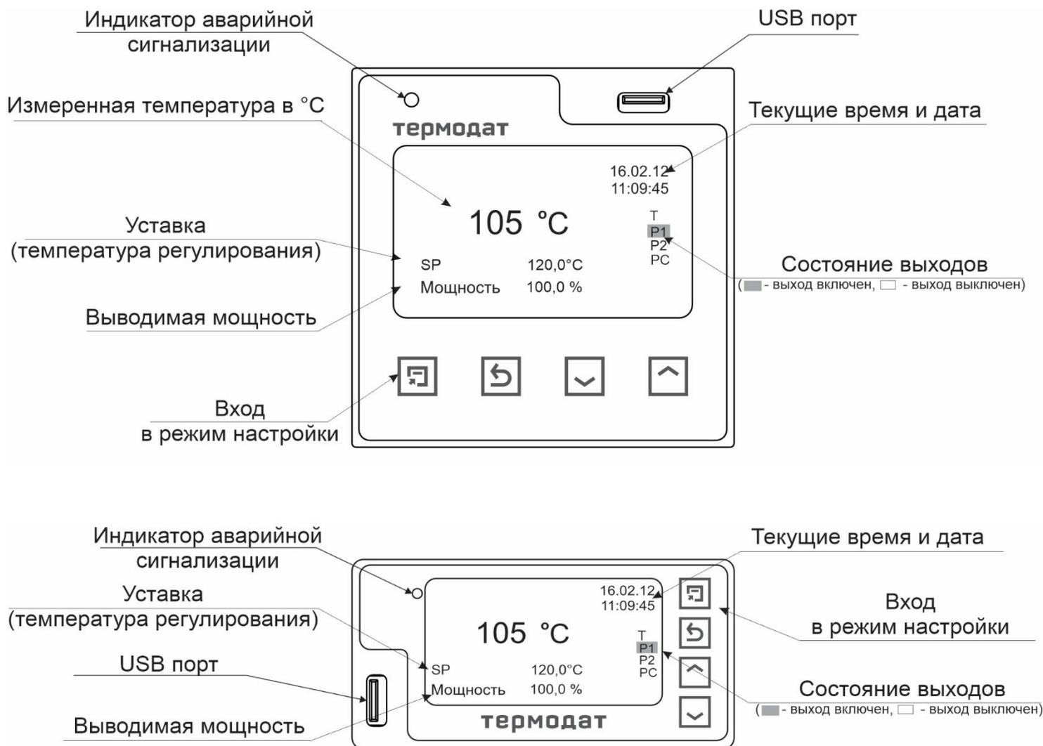
Рисунок 3 - Режим индикации «Текст- значение крупно»
