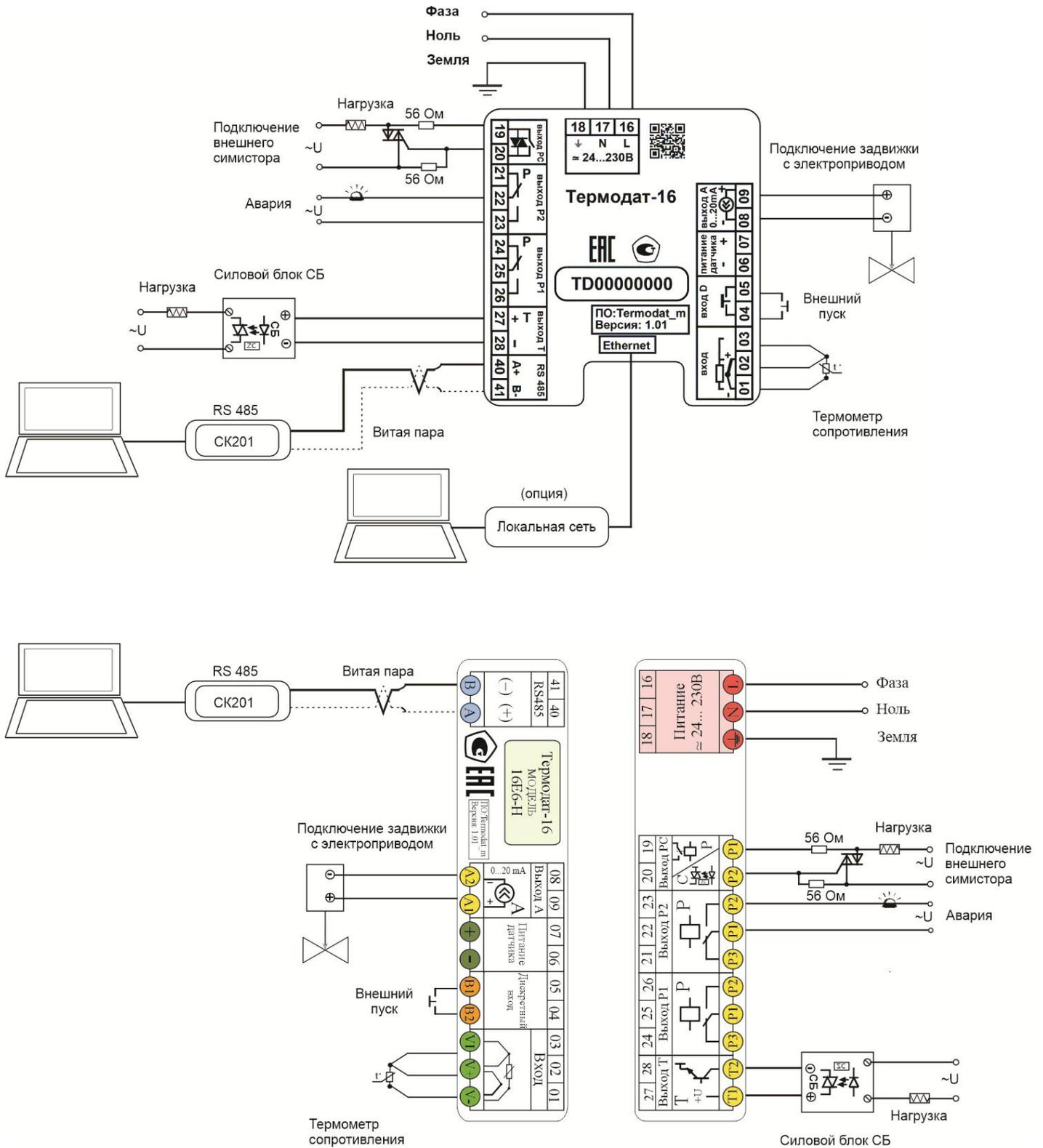
Рисунок 14 – Схема подключения прибора
