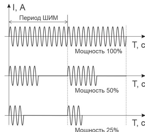
При **методе равномерно-распределенных рабочих сетевых периодов (РСП)** ток через нагреватель периодически включается на один или несколько сетевых периодов. Мощность нагревателя испытывает меньшие колебания во времени, чем при использовании ШИМ. Этот метод очень хорош в лабораторных условиях при малых мощностях нагревателя. Не используйте метод при мощностях более 5 кВт. Недопустимо использование метода РСП при индуктивной нагрузке.
