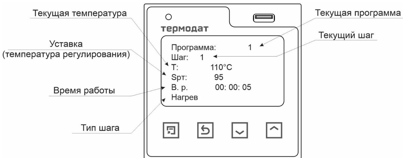
Рисунок 4 - Режим индикации «Текст- состояние программы»
