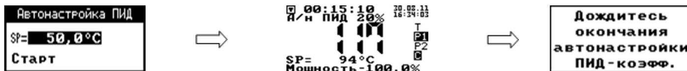
Если в процессе настройки произошел сбой (например, прибор был обесточен), то высвечивается сообщение об ошибке.
