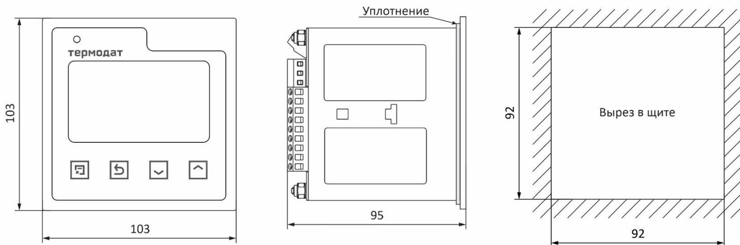
Рисунок 16 – Габаритные размеры прибора Термодат-16Е6-А7
