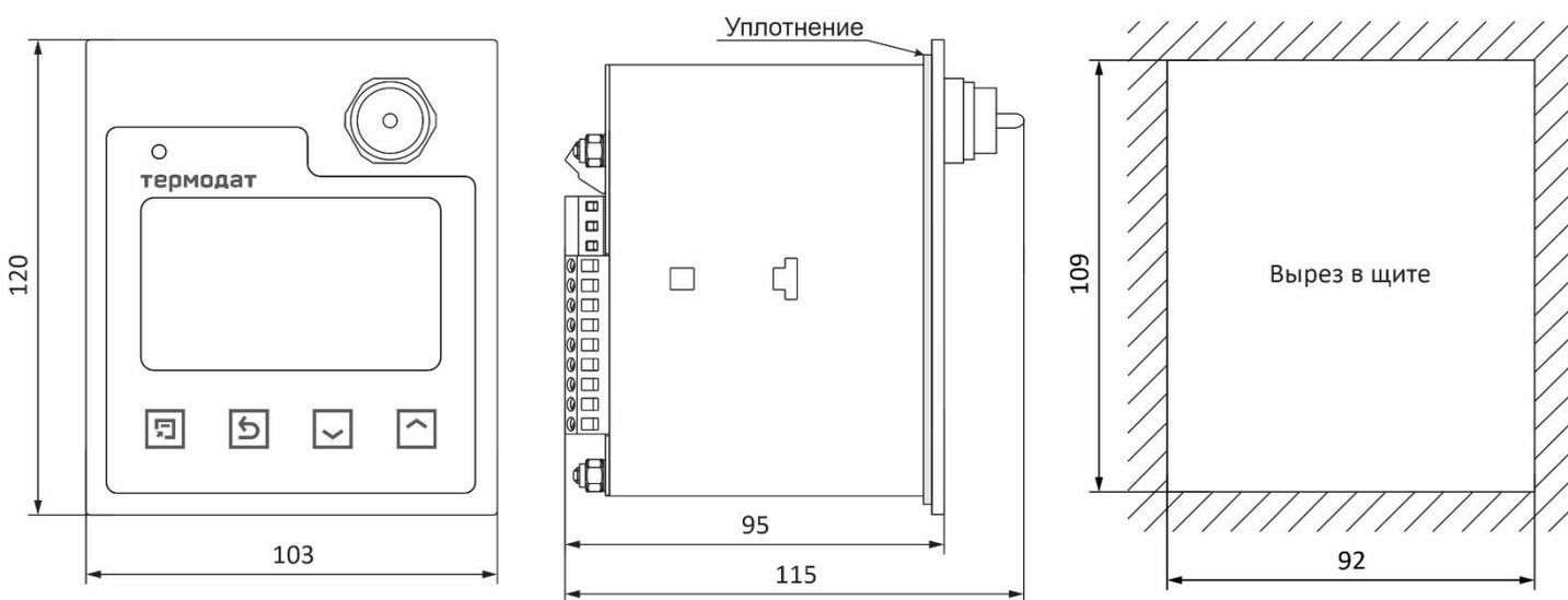
Рисунок 17 – Габаритные размеры прибора Термодат-16Е6-А9-F
