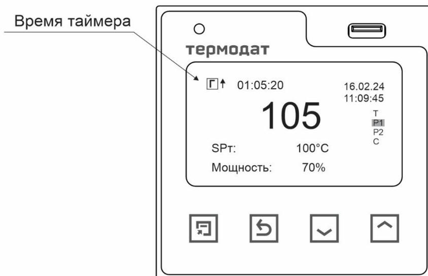
Рисунок 8 – Внешний вид прибора с включенным таймером
