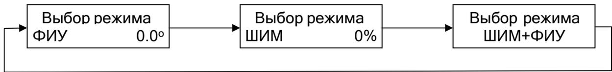
Подтверждение выбора и переход к выбору входа управления производится нажатием кнопки  $\square$ , а выбор осуществляется опять же кнопками  $\nabla$  и  $\Delta$ . В зависимости от выбранного метода регулирования будет предложено выбрать либо управление для ФИУ, либо для ШИМ. В случае выбора метода ШИМ+ФИУ нужно будет выбрать соответствующий вход управления для каждого из этих методов.
