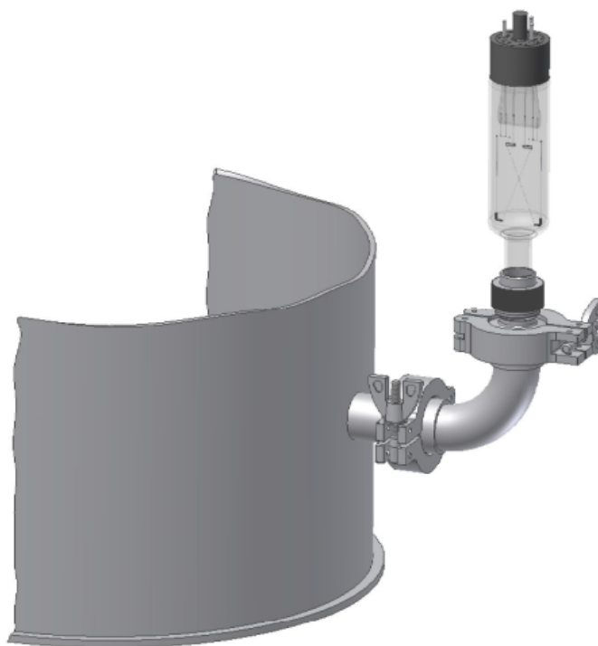
Схема подключения датчика ПМТ-2 к вакуумной системе
