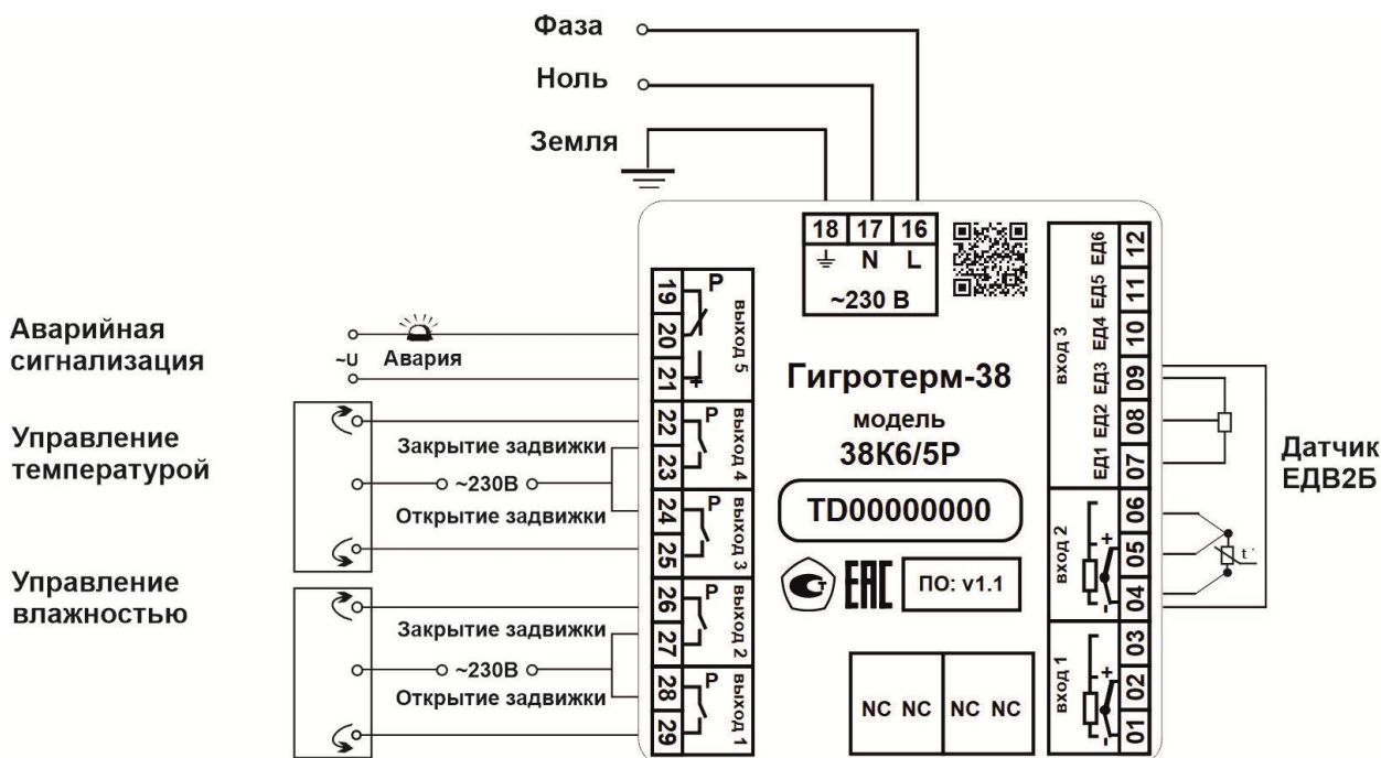
Схема 1. Регулирование влажности и температуры с использованием электрозадвижек. Для измерения влажности и температуры применяется датчик ЕДВ2Б
