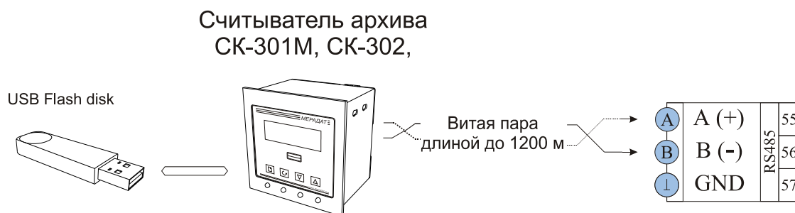
Рис 5.4 Типовая схема подключения прибора к считывателям архива.
